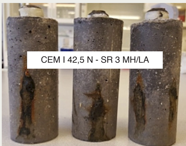
Bilderna visar skillnad i korrosionshärdighet mellan två olika bindemedel.
